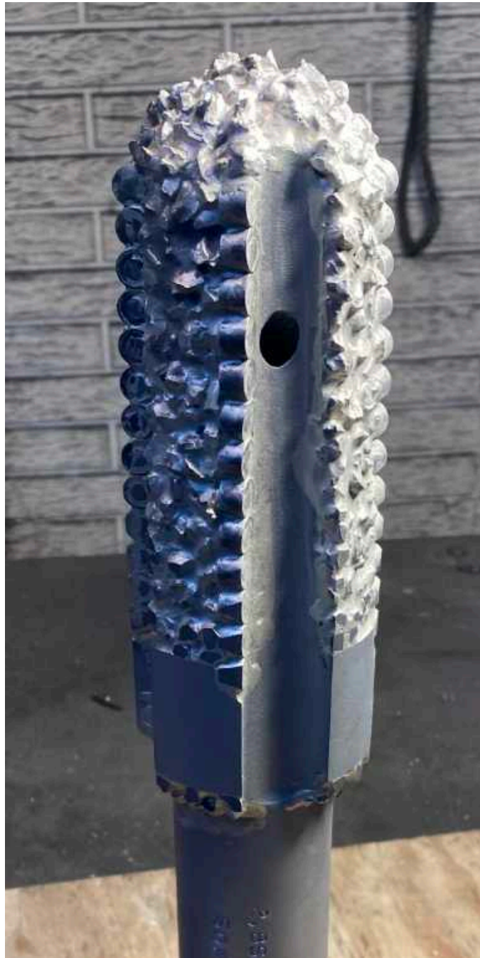
SKR Tapered Reamer 2 deg taper per side .035" per side taper per inch
